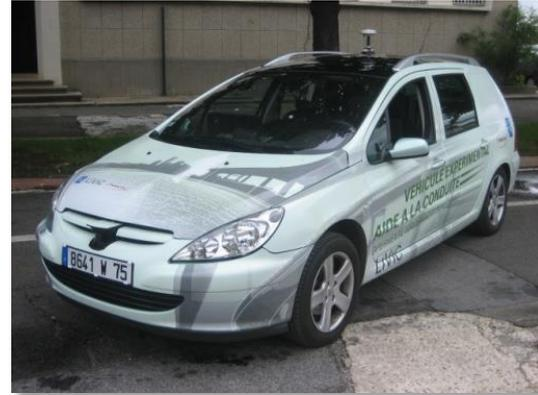
Pilotage Répétable : Robot de conduite + Ixsea + RTK
